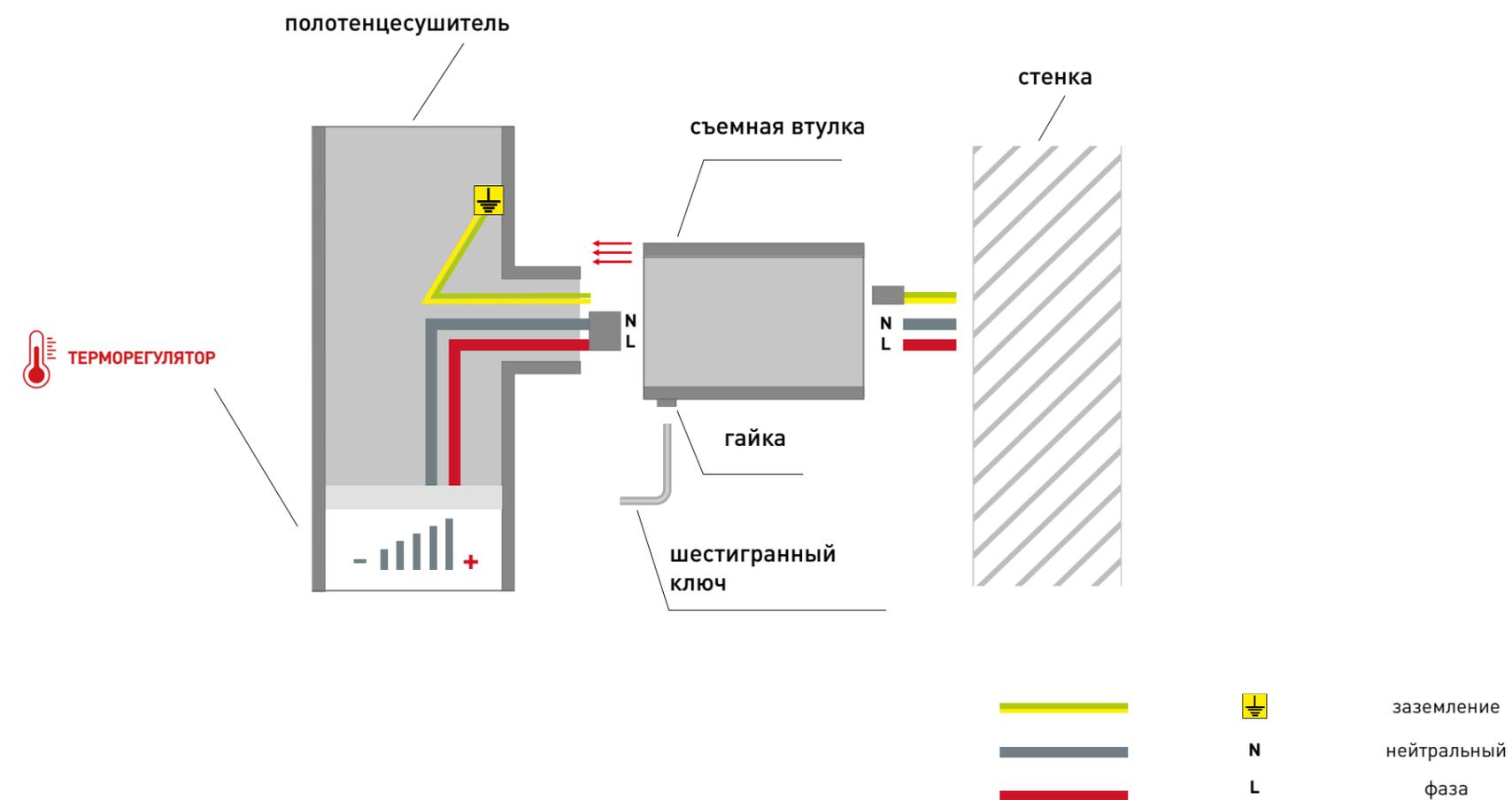
Схема 2. Подключение при помощи кабель-вилки
