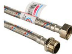
Гибкая подводка для воды Gigant используется для подключения бытовых приборов и оборудования к системе водоснабжения или отопления. Представляет собой шланг из EPDM-резины, предназначенной для питьевого водоснабжения, в оплетке из нержавеющей стали.
