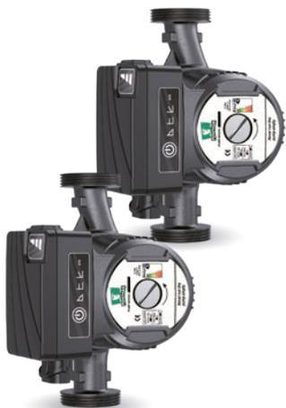
Циркуляционные насосы серии GRA на постоянных магнитах с частотным управлением и автоматическим режимом работы. Может работать с постоянной скоростью, перепадом по давлению, поддерживать постоянное давление или автоматически настроиться под систему. Рабочая камера защищена от коррозии катафорезным покрытием. Резьбовые соединения в комплекте. Предназначены для быстрой циркуляции в системах отопления, кондиционирования и теплого пола.
