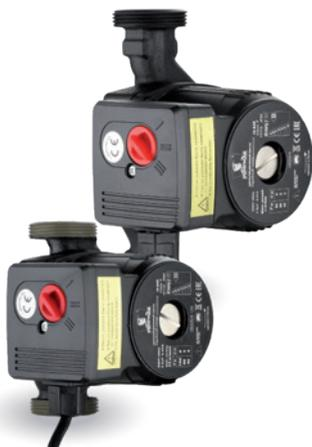
Циркуляционные трехскоростные насосы серии GRS являются одноступенчатыми насосами с горизонтальным расположением вала и рабочим колесом одностороннего входа. Корпус насоса защищен от коррозии катафорезным покрытием. Предназначен для быстрой циркуляции воды/теплоносителя в закрытых системах кондиционирования, отопления и в трубопроводах горячего водоснабжения. Резьбовые соединения в комплекте.
