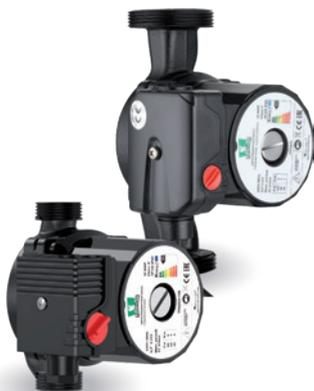
Циркуляционные трехскоростные насосы экономерии TRS являются одноступенчатыми насосами с горизонтальным расположением вала и рабочим колесом (крыльчаткой) одностороннего входа. Предназначен для быстрой циркуляции воды/теплоносителя в закрытых системах кондиционирования, отопления и пола. Шнур питания и резьбовые соединения в комплекте.
