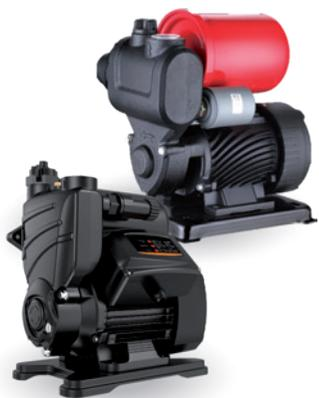
Насосные станции серии TGP и TWE с реле давления и гидроаккумулятором, на основе насоса поверхностного нормально всасывающего вихревого моноблочного насоса, предназначены для использования в системах водоснабжения для повышения давления. Станции TWE с электронным управлением, защитой по сухому ходу, защитой по току и плавным пуском/остановкой. Работает в автоматическом режиме.
