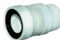
Слив для унитаза раздвижной АНИ 212-320 мм, с гладким выпуском на 110 мм, с резиновой манжетой
