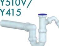
СИФОН ДЛЯ ТЮЛЬПАНА, УМЫВАЛЬНИКА, МОЙКИ ПРЯМОТОЧНЫЙ без выпуска 1 1/2" (Ø40) резьбовой переходник 40×32 отвод для стиральной/посудомоечной машины / без отвода отвод в канализацию Ø40
