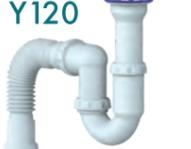
СИФОН ДЛЯ ТЮЛЬПАНА, УМЫВАЛЬНИКА, МОЙКИ ПРЯМОТОЧНЫЙ литой выпуск 1 1/2" (Ø40) винт 6×80 чашка из нержавеющей стали гибкий отвод в канализацию Ø40×40/50
