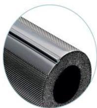
Thermafex Ultra M - трубная изоляция на основе вспененного полиэтилена с полимерным покрытием, обеспечивающим защиту от ультрафиолетового излучения и механических воздействий, с повышенной защитой от агрессивных сред. Снабжена пластиковым замком- защелкой для быстрого и надежного монтажа. Используется для сантехнических, отопительных, холодильных, вентиляционных систем, в пищевых и фармацевтических
