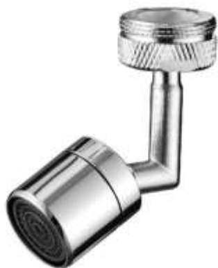
Насадка на кран ECO с регуляцией направления струи M24-F22 хром МКР21038BL
