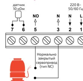
Если используется сервопривод с нормально-закрытым контактом (NC), фазный провод от сервопривода L1 подключается на контакт (5), нулевой N1 на контакт (3).
