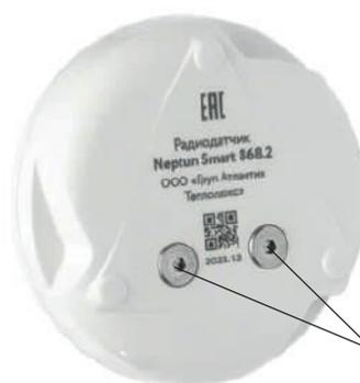
Пластины-контакты датчика контроля протечки воды
