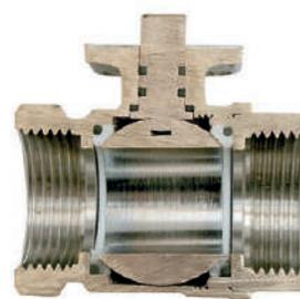
Корпус крана произведен из латуни CW617N методом горячейковки, что полностью исключает появление скрытых микропустот внутри металла и обеспечивает прочность изделия.
