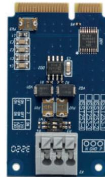
Модуль расширения RS485 служит для интеграции в автоматизированные системы управления с поддержкой протокола MODBUS RTU. Поддерживаются скорости передачи от 1200 бит/с до 921600 бит/с без контроля четности.
