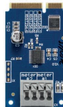
Модуль расширения Счетчики воды предназначен для считывания показаний с импульсных приборов учета расхода воды. Показания хранятся в энергонезависимой памяти модуля расширения. К одному модулю расширения можно подключить до 2 счетчиков. Настройка модуля расширения производится с помощью приложения. Обновление показаний со счетчиков происходит каждые 20 минут. Модуль расширения также поддерживает работу со счетчиками с выходом по стандарту NAMUR (настраивается через приложение).
