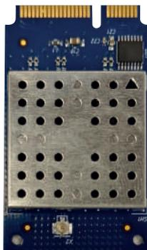
Модуль расширения Радиодатчики предназначен для организации соединения с беспроводными датчиками контроля протечки воды. Посредством радиомодуля можно подключить до 50 беспроводных датчиков протечки воды.
