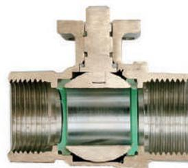
Корпус крана произведен из латуни CW617N методом горячейковки с дополнительной пескоструйной обработкой, что полностью исключает появление скрытых микропустот внутри металла и обеспечивает прочность изделия.
