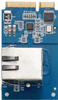
Модуль расширения Ethernet служит для сетевого подключения модуля управления к маршрутизаторам в случае невозможности организации беспроводного подключения к сети Wi-Fi.
